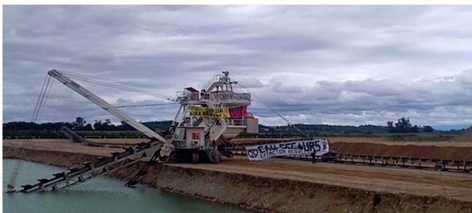
L'extraction des granulats, par creusement en profondeur, parfois jusqu'au socle, met la nappe souterraine à nu et l'eau se trouve exposée à l'air libre dans les trous d'excavation, ce qui entraîne son évaporation.
